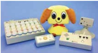
システムは、映像・音声と複合通信機能を持つ①「見守り介護ロボット・ケアロボ」と高性能センサー・徘徊センサー・認知症ケア製品・呼出スイッチ・見守りセンサー等を無線通信で結合した②ケア製品包括ネットワーク③携帯電話通信で構成するシステム製品として地域高齢者ケアを包括的に支援するもので、特に24時間対応の「定期巡回・随時対応型訪問介護看護サービス」において機能を最大に発揮する製品です。一部機能では「認知症老人徘徊感知機器」として貸与マークを取得しております。
