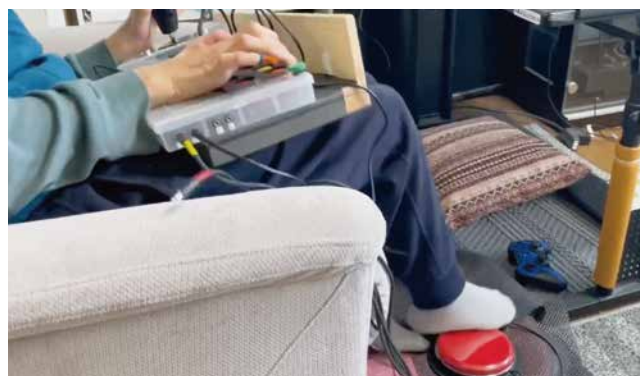
足の裏でボタンを操作できるようにアレンジした当事者用のコントローラー。
